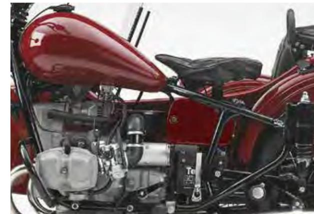
Raffiniert: Das Chassis des Vorgängermodells Retro gaukelte eine Geradwegfederung vor. Tatsächlich stützten die Dämpfer eine Schwinge ab.
