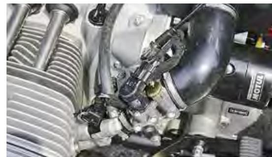
Nachgelegt: Einspritzanlage mit Leerlaufregelung, dickere Zylinderrippen, effektivere Schmierung.
