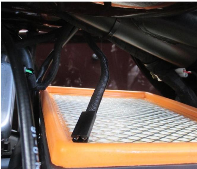
Montieren Sie den Aktivkohlefilter am rechten vorderen Rahmenzug mit den mitgelieferten Schellen.
