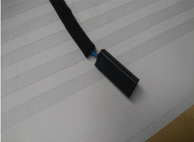
Das Anschlußkabel liegt versteckt zwischen Tank und Luftfilterdeckel. Entfernt man den Luftfilterdeckel, fällt das Kabel schon entgegen.
