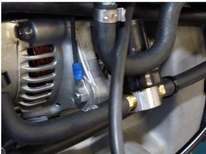
Verbinden Sie das 2. Kabel mit der Abzweigung aus dem Kabelbaum unter dem Tank (blaues Kabel mit rotem Streifen)
