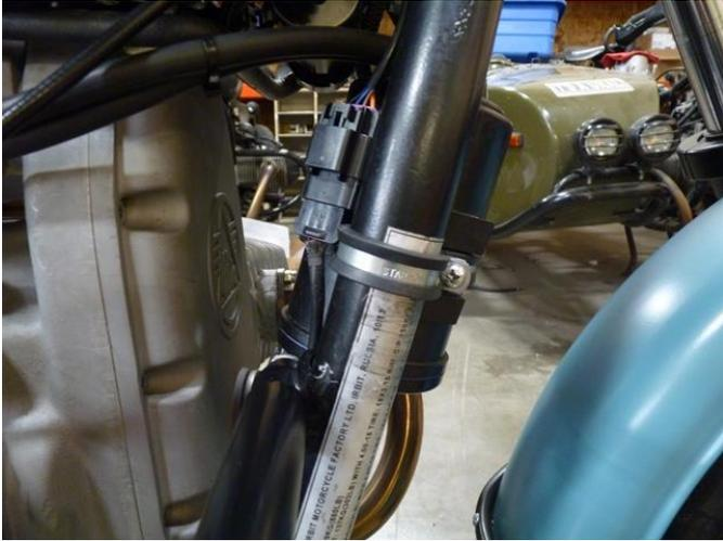
Zwischen Tankanschluss und Magnetventil das Überschlagventil einbauen.
