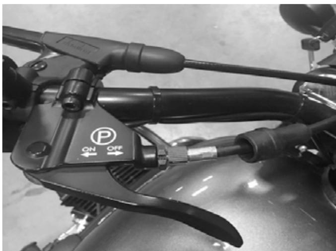
Das Feststellbremskabel kann in der Off-Position mittels der Einstellmutter am oberen Ende des Bremsseils eingestellt werden.
