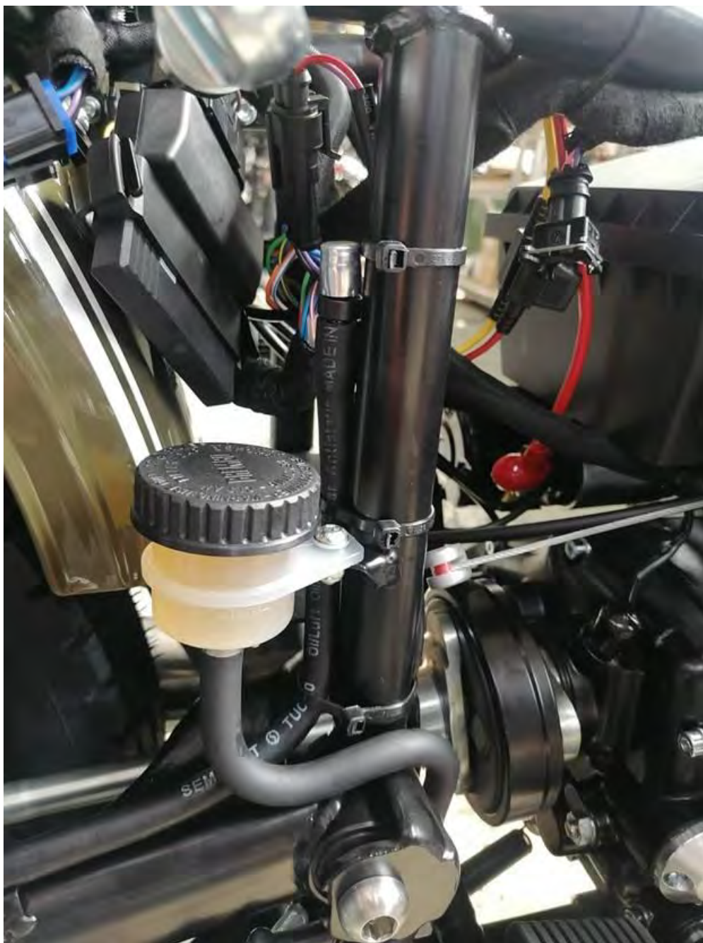
Установка сапуна новой конструкции на мотоцикл 2 WD Installation of a new design breather on the motorcycle 2 WD
